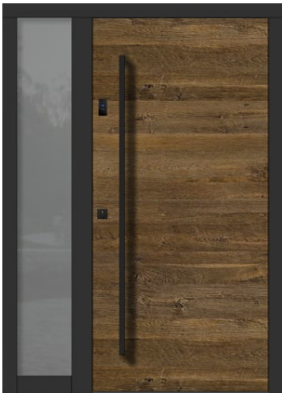
G-H401 Türblatt außen Altholz Eiche quer, Typ 4E Türblatt innen Eiche quer, Farbton 315 Rahmen innen & außen RAL7021 Außenrosette SZEP, Stoßgriff SQ160 schwarz Innendrücker GE540 Edelstahl EAV-Schloss mit Fingerprint FP1 schwarz Seitenteil ST01 Glas Seitenteil Satinato weiß
