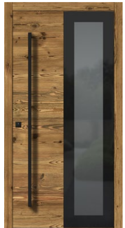
G-H409 Türblatt und Rahmen außen Altholz Fichte quer, Typ 3B Türblatt und Rahmen innen Fichte quer, 313 Glas Parsol grau mit Email schwarz, mittig Klarglas Außenrosette SZEP, Stoßgriff SQ160 schwarz Innendrücker GE540 Edelstahl EAV-Schloss mit Fingerprint FPI schwarz
