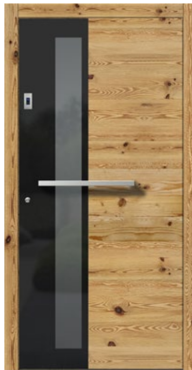
G-H408 Türblatt und Rahmen außen Altholz Fichte quer, Typ 3A Türblatt und Rahmen innen Fichte quer, 313 Glas Parsol grau mit Email schwarz, mittig Klarglas Außenrosette ZAR, Stoßgriff GQ55 Edelstahl Innendrücker GE540 Edelstahl EAV-Schloss mit Fingerprint FPI Edelstahl
